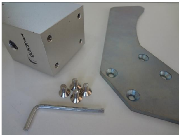
Figura 1 – Parafusando o apoio dos pés a base da bomba
