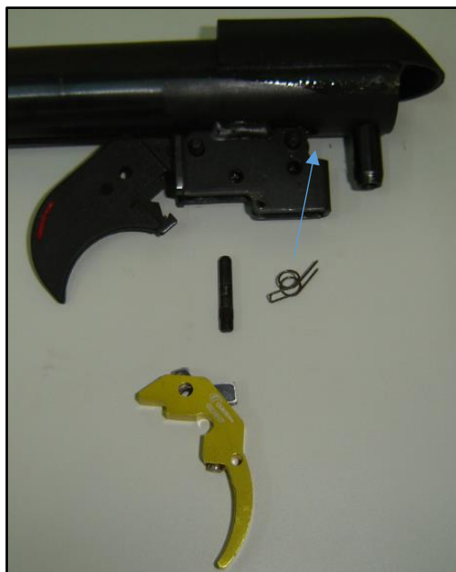
Imagem 3 – Instalação da mola do desconector
