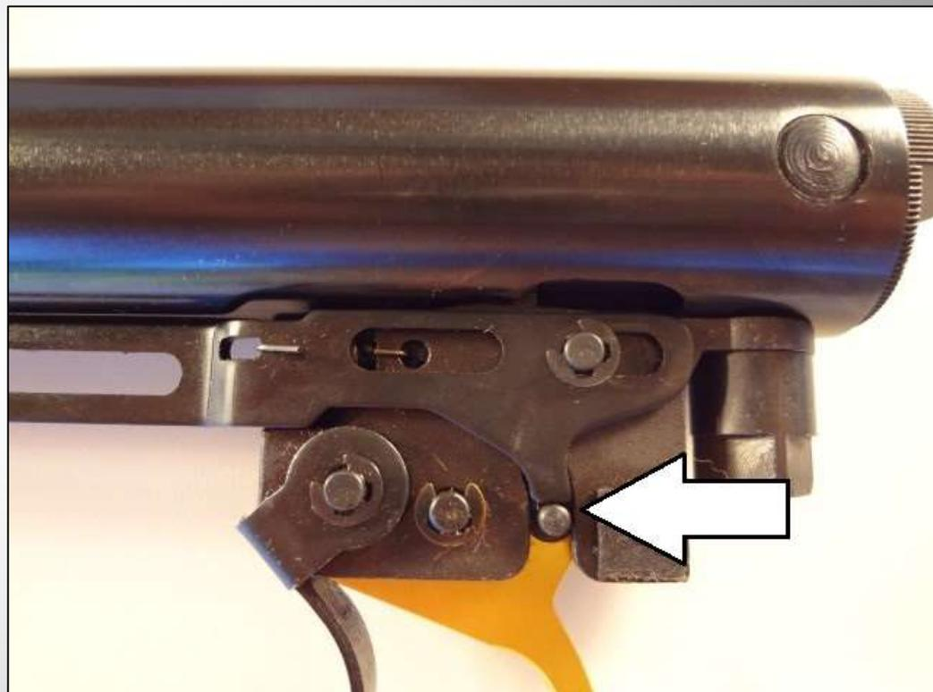
**Com a trava de segurança na posição *Fire*, abra o cano da carabina e verifique se a haste de segurança trava a lâmina de gatilho corretamente ao deslizar.**
