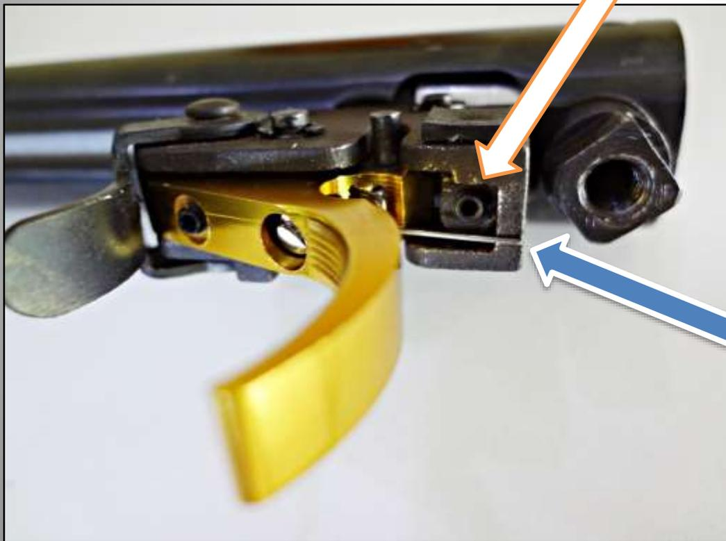
A mola de torção deve ficar com a ponta para fora da caixa, conforme foto.
