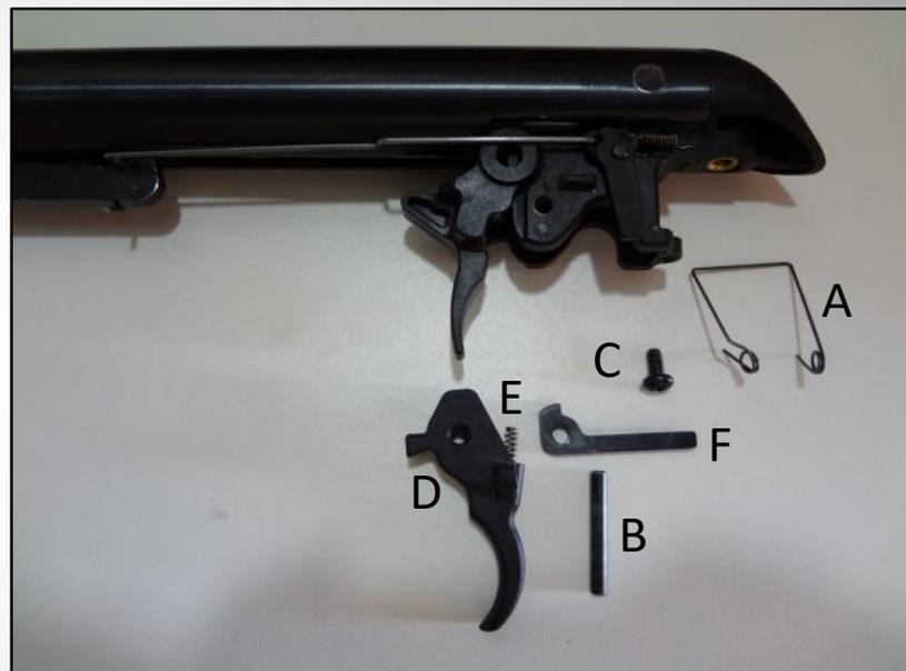
Para remover a lâmina original você deve: retirar a mola que envolve a caixa de gatilho (A) e remover o pino do gatilho (B). Retire também o parafuso de ajuste Philips (C) (Apenas para Jade Mais).
