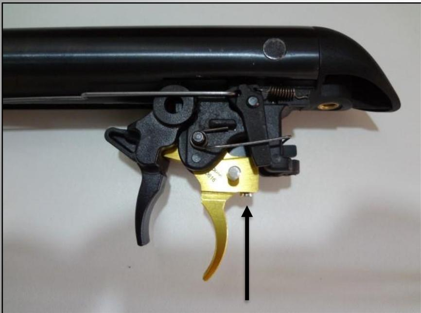
Recomenda-se o uso de chave de fenda ponta chata com medidas de até: 3 x 100, 3 x 125 ou 3 x 150 (Ponta de 3mm com haste de 100, 120 ou 150mm)
