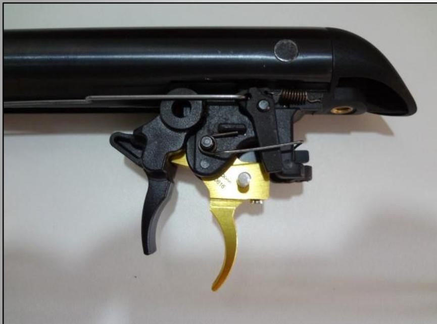
A montagem segue a sequência inversa: Encaixe a nova lâmina de gatilho ajustável com o desconector alinhados através do furo da lâmina de gatilho na caixa de gatilho, recoloque o pino e recoloque a mola que envolve a caixa de gatilho.
