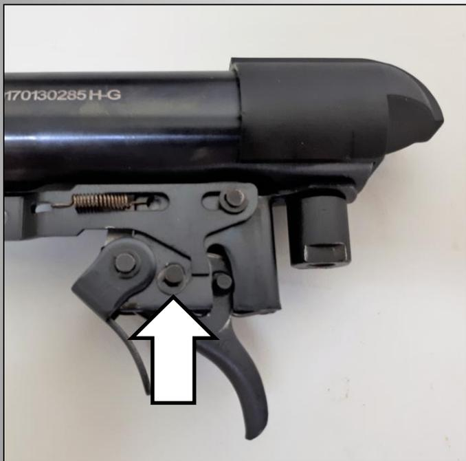
Com uma chave de fenda pequena ou uma chave de ponta fina, remova apenas o anel elástico da lâmina do gatilho, conforme ilustrado na foto.
