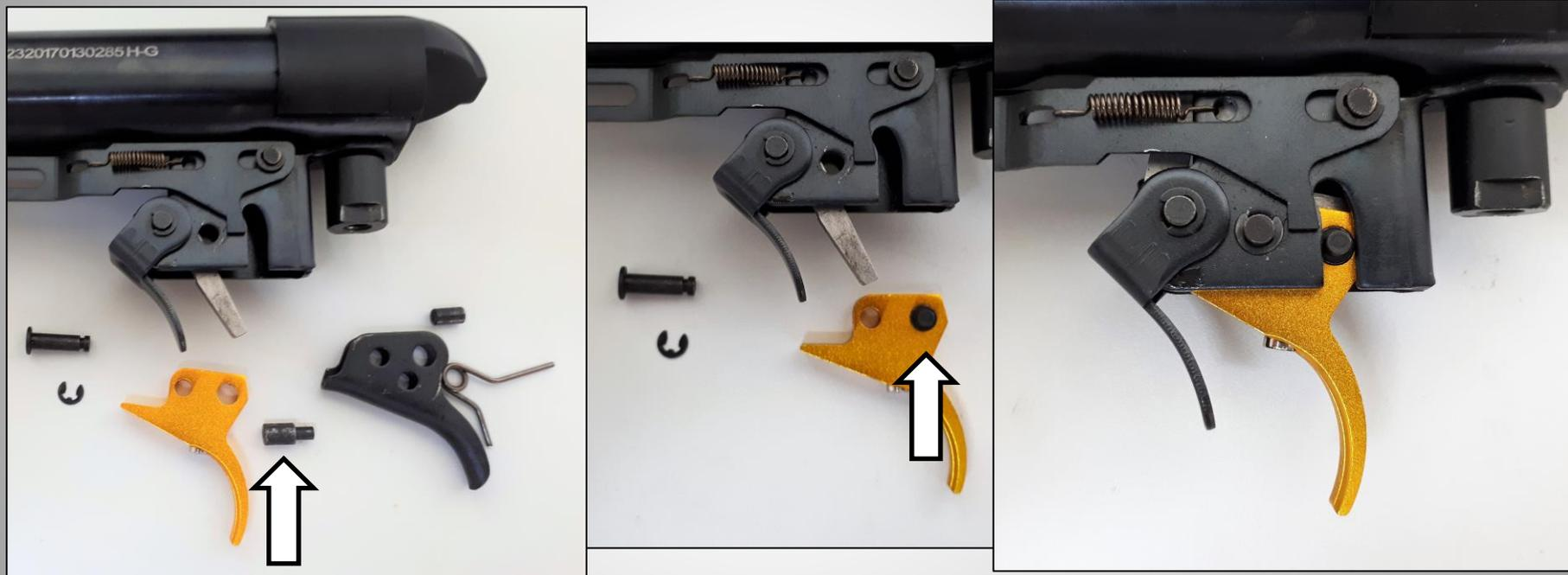
Retire o pino de segurança que atua na trava de segurança da carabina, da lâmina do gatilho. Encaixe na nova lâmina ajustável.
