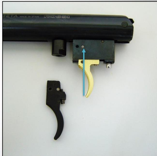
Agora instale a nova lâmina, colocando o pino no furo indicado pela seta.
