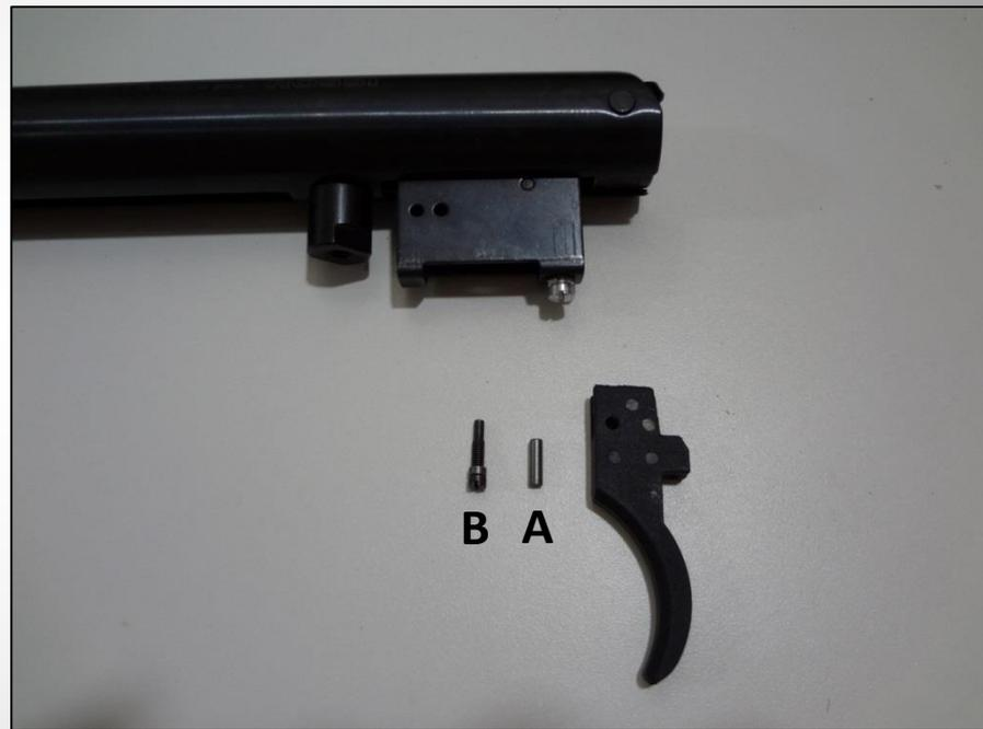
Com uma chave de fenda pequena ou uma chave de ponta fina, remova o pino (A) ilustrado na foto. Ao remover o pino, a lâmina de gatilho original será liberada. Retire completamente a antiga lâmina da caixa de gatilho.
