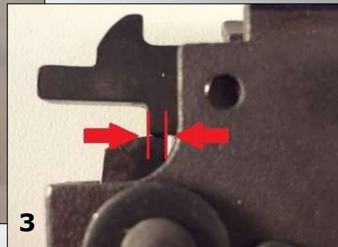
A lâmina ajustável, através de seu parafuso de ajuste principal (1), atua diretamente no desconector (2), alterando a sobreposição do metal entre o desconector e a trava do êmbolo (3). Desta forma, é possível ajustar o conjunto deixando mais pesado ou leve, de acordo a necessidade do atirador.
